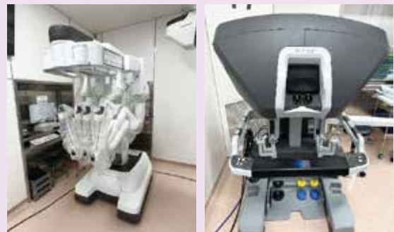
左:実際のロボットアーム 右:術者はこちらの器械を操作し、左のロボットアームを操作します。
